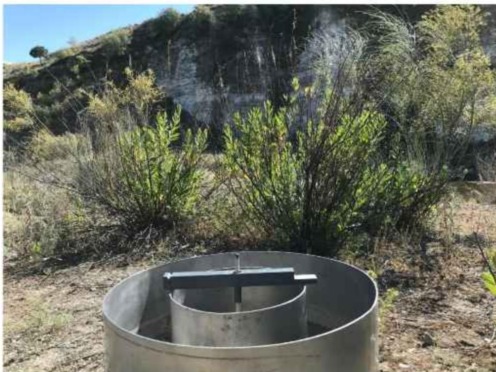
Figura 22. Punto 2: ORILLA. Infiltrómetro de doble anillo con el que se realizó la prueba de infiltración.
