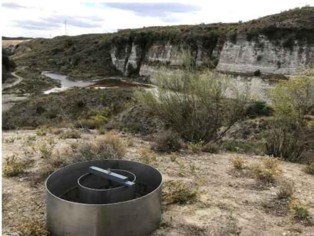
Figura 20. Punto 1: CIMA. Infiltrómetro de doble anillo con el que se realizó la prueba de infiltración.
